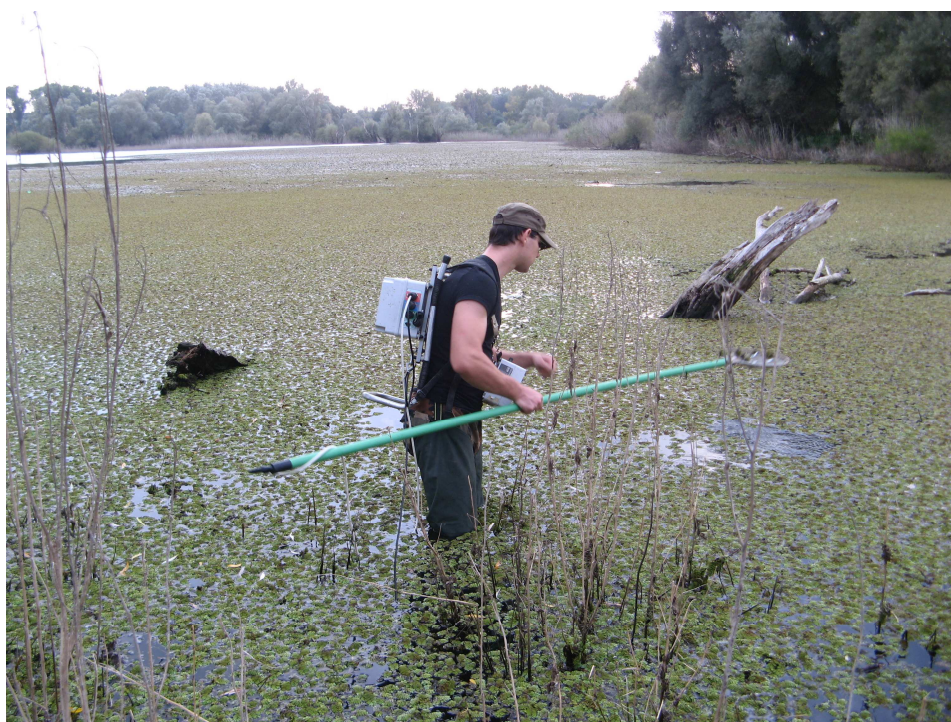
Slika 2. Uzorkovanje riba pomoću lednog baterijskog agregata u dravskoj mrtvaji. Fotografirao: T. Mikuška.
