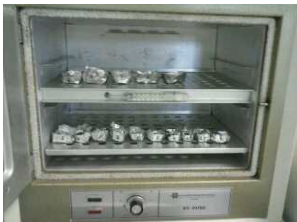
Slika 6. Određivanje mase suhe tvari, sušionik (autorska fotografija).
