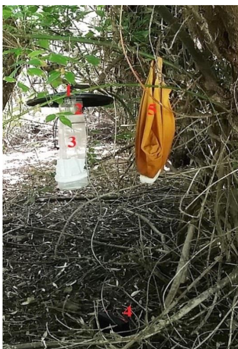
Slika 15. CDC klopka: Poklopac (1), cilindar s ventilatorom (2), mrežica (3), baterija (4), platnena vreća sa suhim ledom (5) (Foto: N. Džojić)
