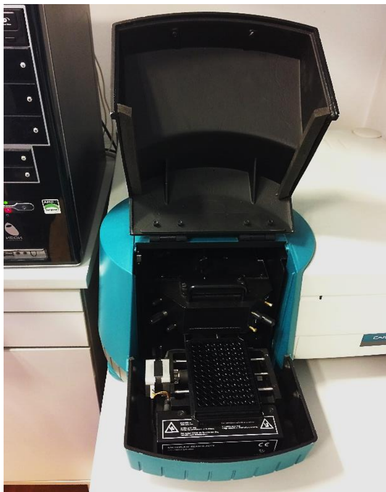
Slika 15. Prikaz jažica s uzorcima u fluorometru (foto: Dora Bjedov).
