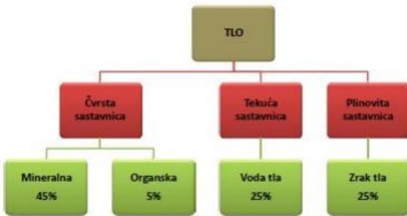
Slika 1. Tlo je trofazni sustav sastavljen od krute, tekuće i plinovite komponente (Web 1)
