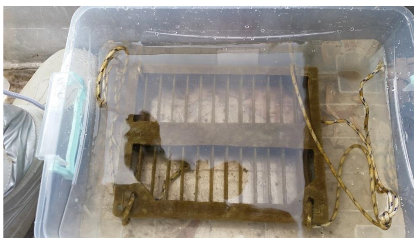
Slika 4: Uzorkovanje umjetnih staklenih podloga iz Sakadaškog jezera (Fotografija: Mario Šimić).
