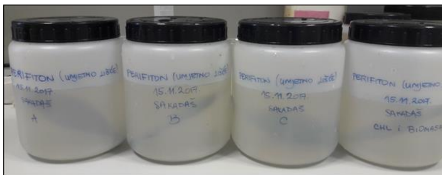
Slika 4. Umjetne podloge (makrofite) u plastičnim posudama ispunjenima jezerskom vodom (fotografirao Nikola Pavlović).
