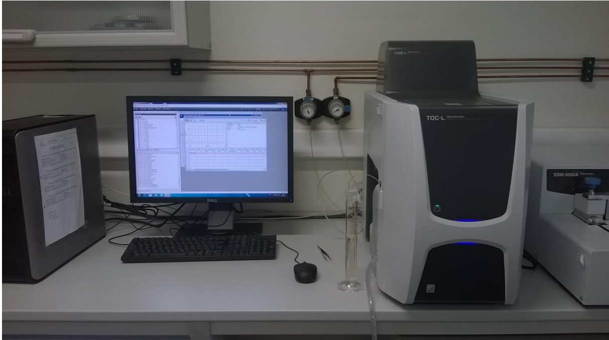
Slika 9: Uređaj za mjerenje ukupnog organskog ugljika i ukupnog dušika
