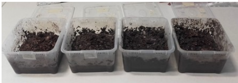
Slika 7: Mikrokozmosi postavljeni na konstantnu temperaturu 20 °C. (T. Đerđ)
