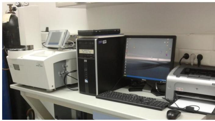
Slika 16. METTLER TOLEDO TGA/DSC System 1
