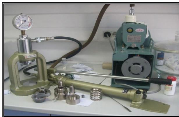
Slika 14. Hidraulična preša i kalup za izradu pastile
