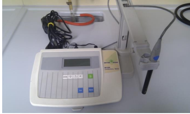
Slika 17. METTLER TOLEDO MC 226 s staklenom kombiniranom elektrodom
