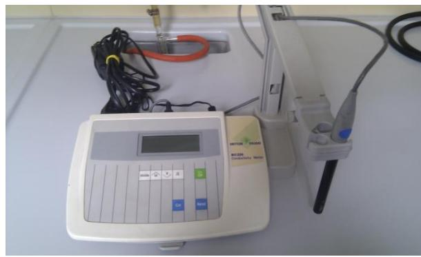
Slika 17. METTLER TOLEDO MC 226 s staklenom kombiniranim elektrodom
