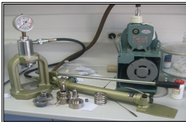
Slika 14. Hidraulična preša i kalup za izradu pastile
