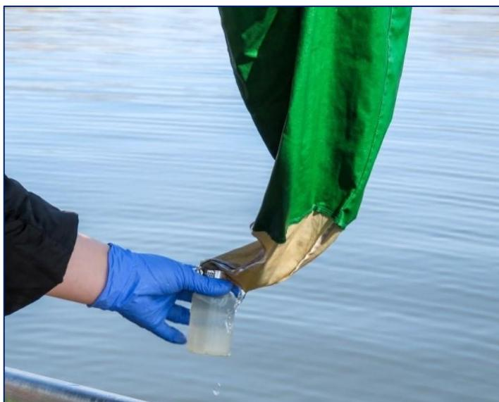
Slika 5. Uzorkovanje fitoplanktona pomoću fitoplanktonske mrežice promjera pora  $20\text{ }\mu\text{m}$
