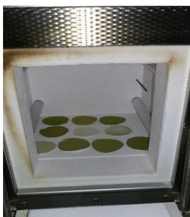
Slika 13. Određivanje ukupne suspendirane tvari (TSS) (Fotografirala: D. Čerba)
