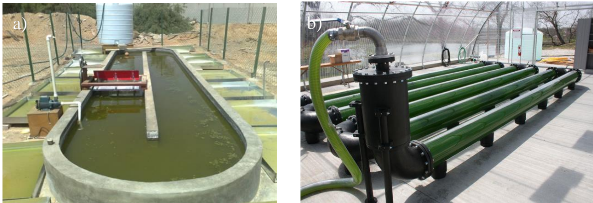
Slika 3. Prikaz a) Otvoreni i b) zatvoreni bioreaktorski sustav za uzgoj alga izvor: (Web 2)
