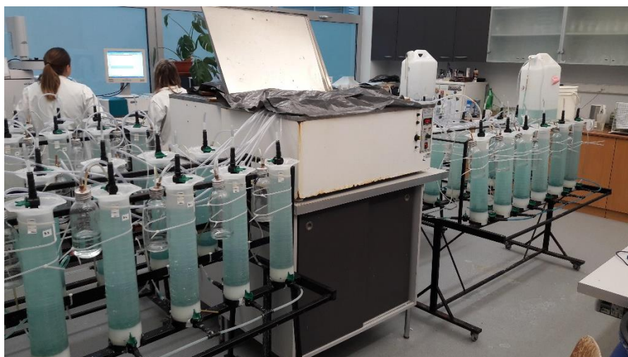
Slika 8. Provedba procesa anaerobne fermentacije izvor: autor
