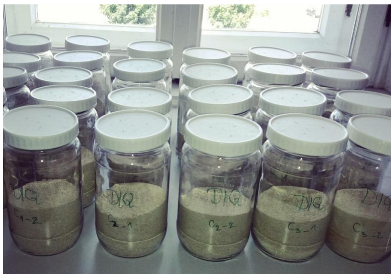
Slika 6. Staklenke sa umjetnim tlom za reprodukcijski test – foto: N. Stjepanović
