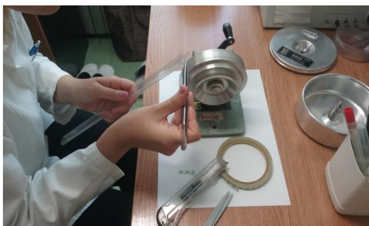
Slika 9: Priprema bubnja s poliesterskom trakom za višednevno uzorkovanje (Foto: Majetić Dajana).
