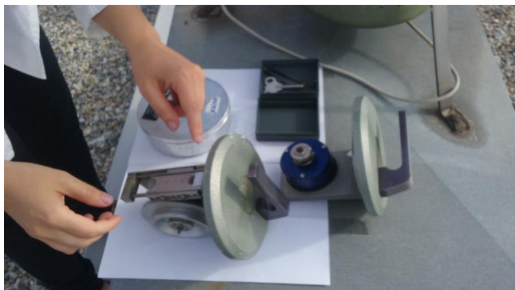
Slika 8: Postavljanje predmetnog stakalaca u Burkardov volumetrijski aparat (Foto: Majetić Dajana).
