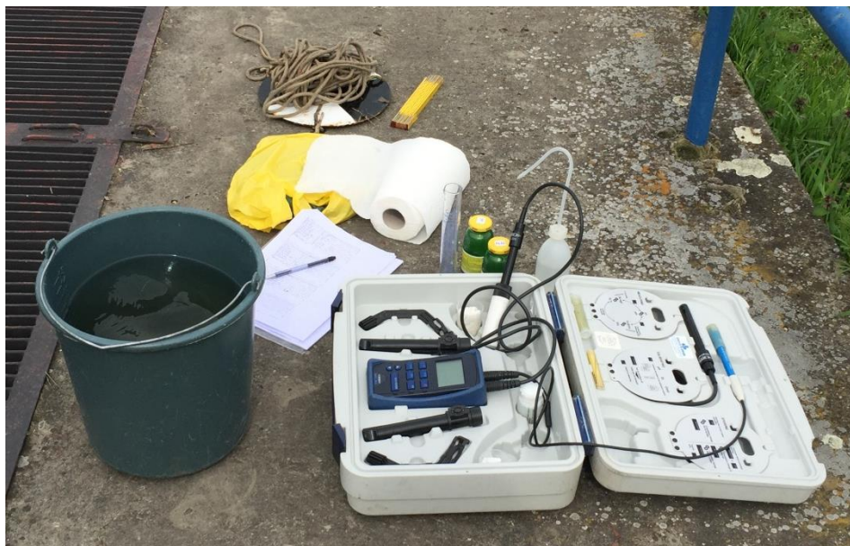
Slika 12. Mjerenje fizikalno-kemijskih svojstava vode (arhiva Zavoda za ekologiju voda)
