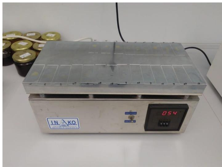
Slika 12. Sušenje preparata na grijaćoj ploči
