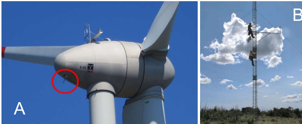
Slika 3.3 A – postavljeni ultrazvučni detektor na gondoli vjetroagregata (Foto: G. Rnjak); B – postavljanje ultrazvučnog detektora na mjerni stup u blizini VE Danilo (Foto: V. Zrnčić)
