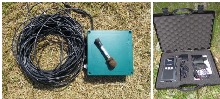
Slika 3.2 Ultrazvučni detektori korišteni za prikupljanje podataka o šišmišima na VE Danilo. A - Song Meter SM2BAT+ za kontinuirano praćenje i B - Elekon Batlogger za transetkno praćenje, (Foto D. Rnjak)
