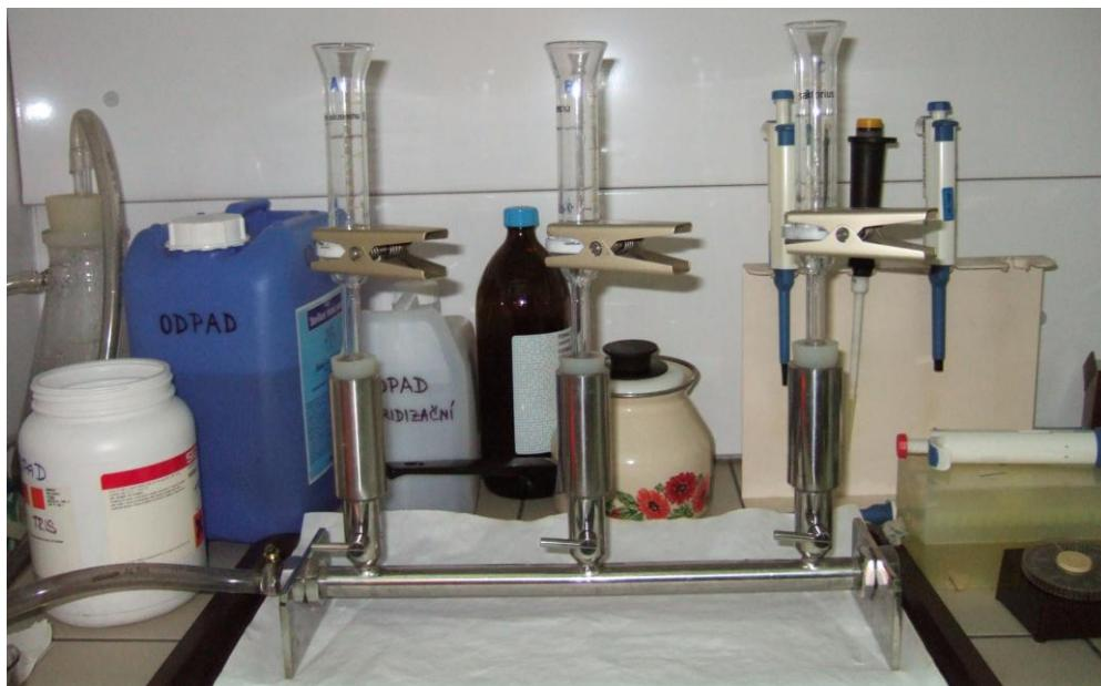
**Slika 7.** Aparatura za filtraciju
