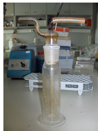
Slika 2. Staklena posuda za pripremu ekstrakta cigaretnog dima (Fotografirala Ivana Mauzer)
