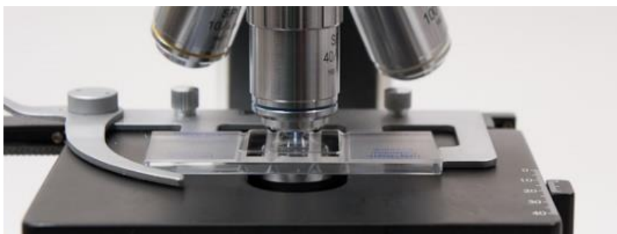
Slika 8. Prebrojavanje celomocita pod svjetlosnim mikroskopom pomoću pomoću Bürker-Türkove komorice (izvor: http://braukaiser.com )
