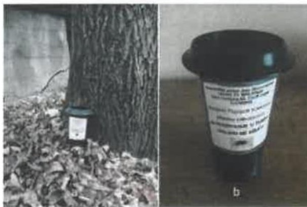
Slika 1a i b. Ovipozicijska klopka Picture 1a & b. Ovitrap (Foto/Photo: I. Terzić)
