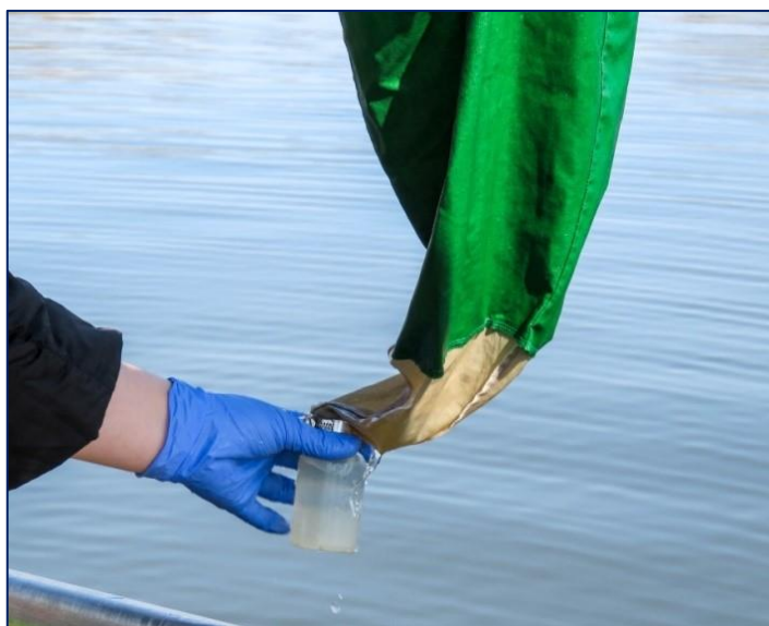
Slika 5. Uzorkovanje fitoplanktona pomoću fitoplanktonske mrežice promjera pora 20 \mu\text{m} (Fotografija: Marija Kovačević)
