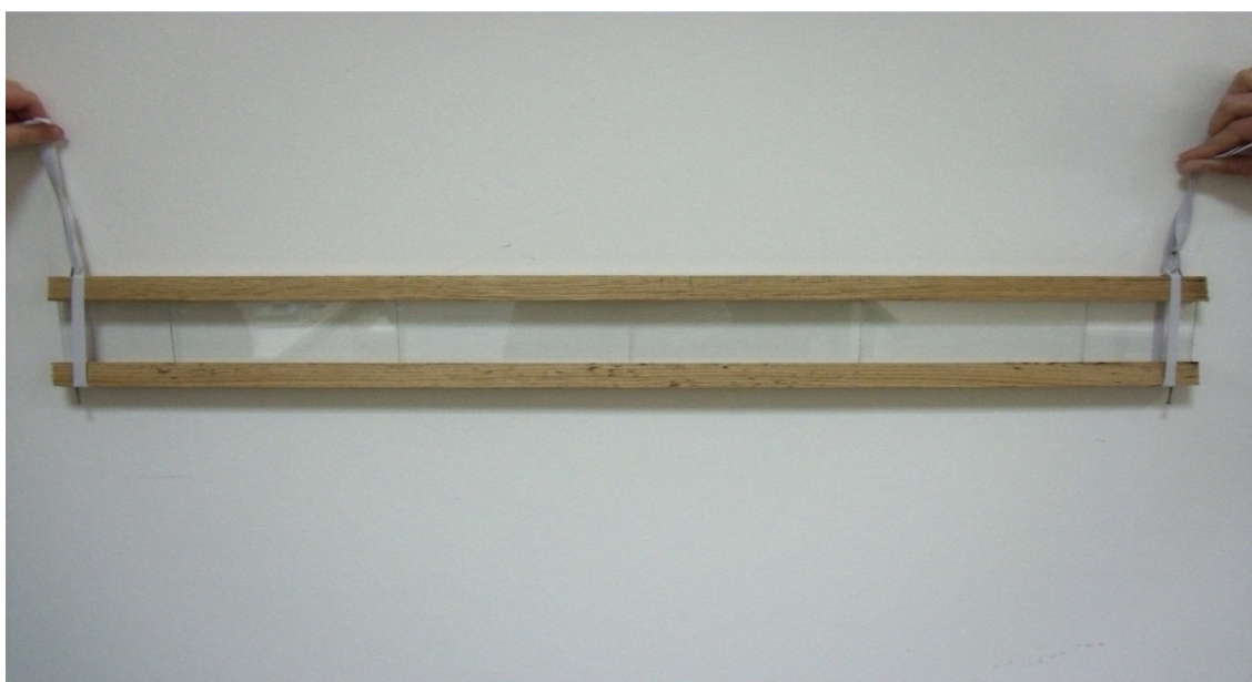
Slika 7. Staklene podloge za praćenje razvoja obraštaja u razdoblju od travnja do lipnja 2011. godine u Sakadaškom jezeru (Fotografija: Zavod za ekologiju voda)
