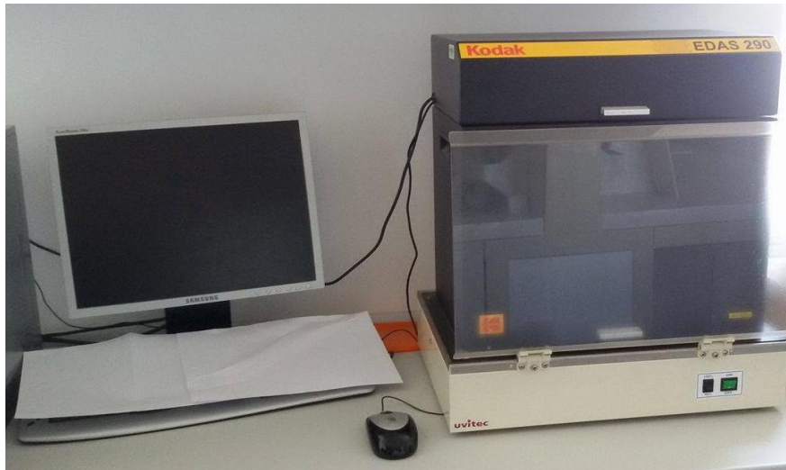
Slika 15. Transiluminator s kamerom Kodak EDAS 290 System
