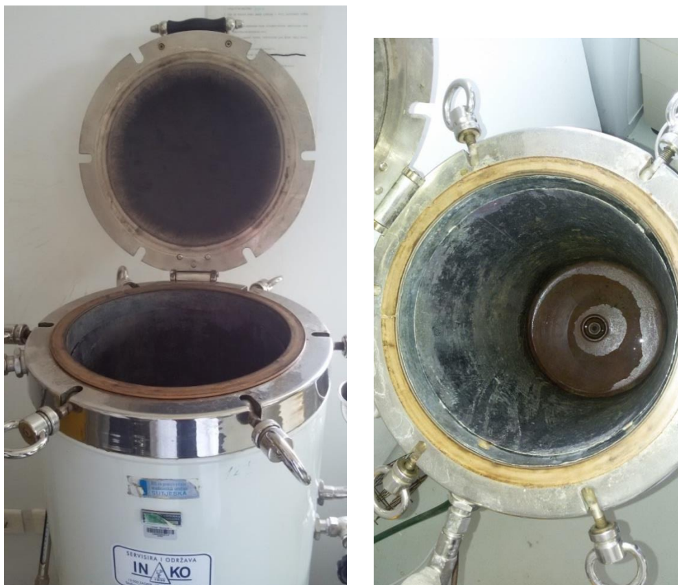
Slika 11. Autoklav (lijevo- vanjski izgled, desno- unutrašnjost) (Autorska fotografija)
