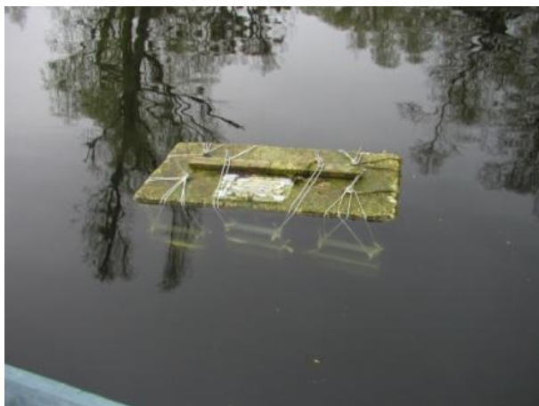
Slika 8: Nosač umjetnih staklenih podloga za istraživanje razvoja obraštaja u Sakadaškom jezeru tijekom 2009. godine.
