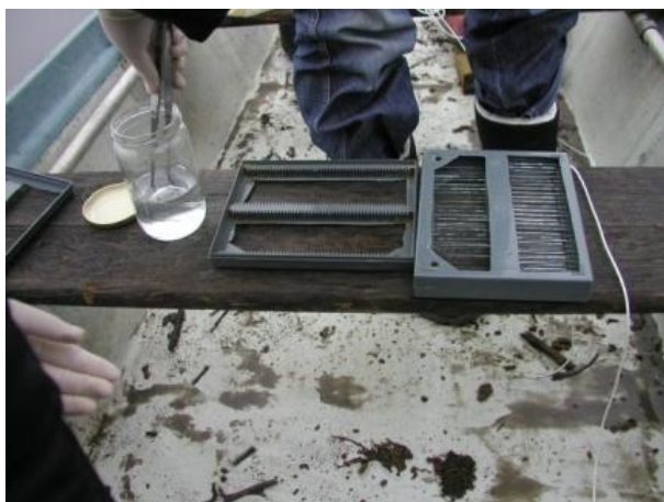
Slika 7: Priprema staklenih umjetnih podloga za istraživanje obraštaja u Sakadaškom jezeru tijekom 2009. godine.
