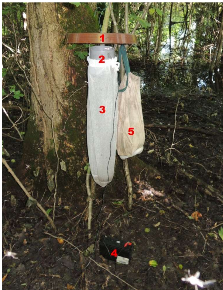
Slika 9. CDC klopka: Poklopac (1), cilindar s ventilatorom (2), mrežica (3), baterija (4), platnena vreća sa suhim ledom (5)
