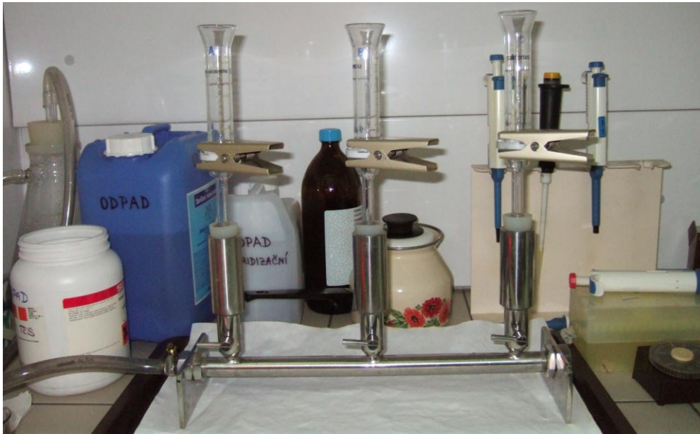
Slika 7. Aparatura za filtraciju
