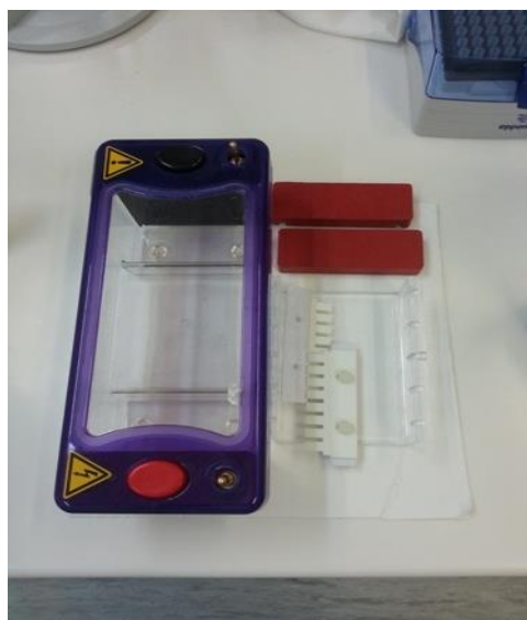
Slika 11. Kada za elektroforezu. Foto: L. Kuna
