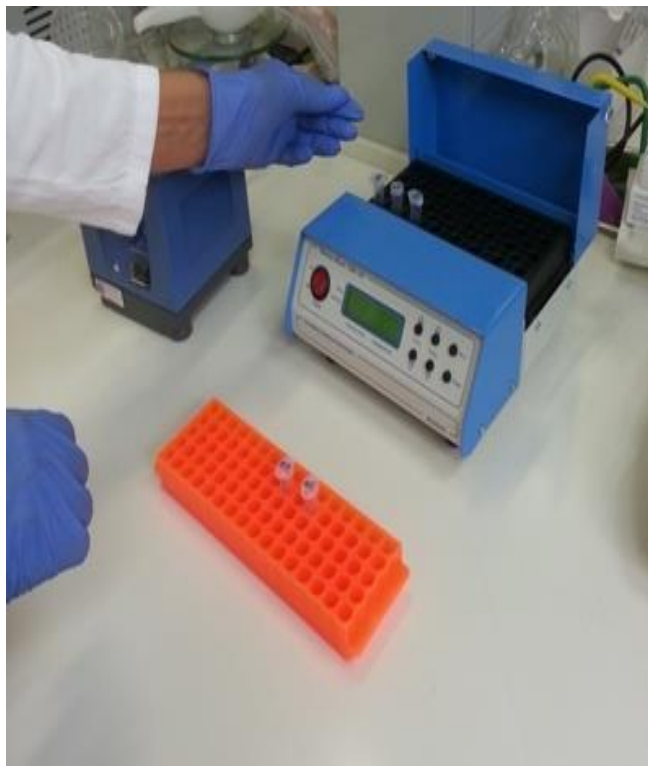
Slika 8. Postavljanje uzoraka na inkubaciju od 56°C, Thermo blok TDB-120. Foto: L. Kuna
