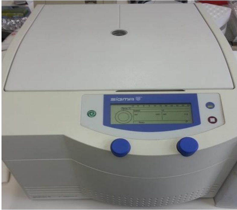
Slika 9. Uređaj za centrifugu, Sigma. Foto: L. Kuna
