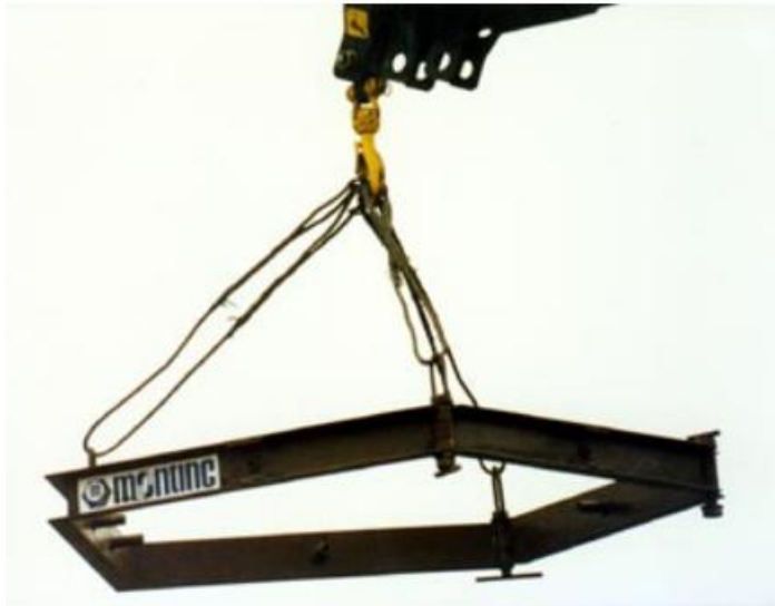
Slika 9. Obruč za premještanje gnijezda (Mužinić, 2000).
