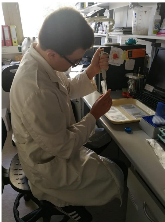
Slika 29. Razmazivanje uzorka na predmetna stakalca pomoću pipete (Foto: M. Sudarić Bogojević)
