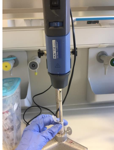
Slika 6. Prikaz vaganja gujavice (lijevo) i homogeniziranja s Ultra-Turrax T10 homogenizatorom (desno) (foto: Tea Tunuković)
