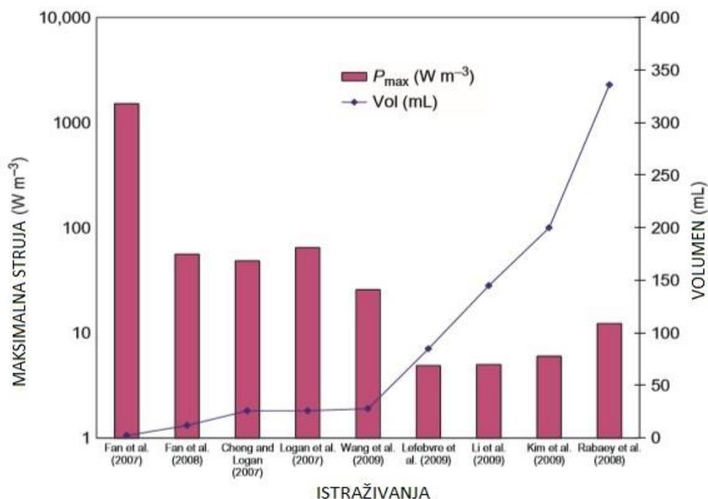
Slika 7. Usporedba istraživanja o odnosu volumena reaktora (Volumen (mL)) i maksimalne električne snage (Maksimalna struja ( $W m^{-3}$ )) u mikrobnom članku s acetatom kao supstratom
