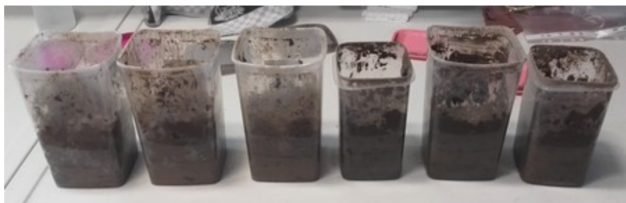
Slika 6: Mikrokozmosi postavljeni na konstantnu temperaturu 16 °C. (T. Đerđ)
