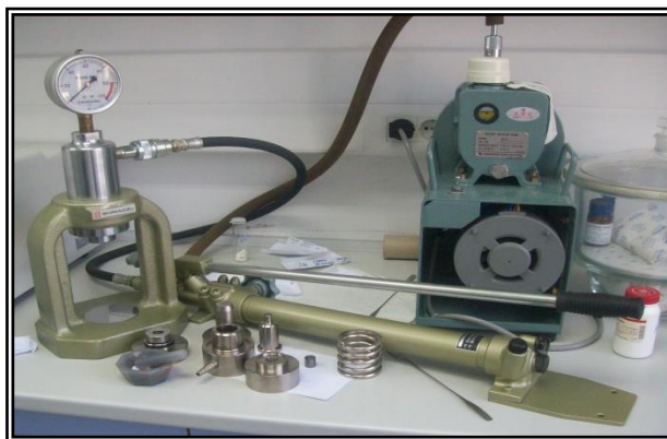
Slika 14. Hidraulična preša i kalup za izradu pastile
