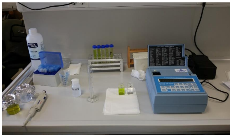
Slika 12. Određivanje koncentracije klorofila a , b i c (Fotografirala: D. Čerba)
