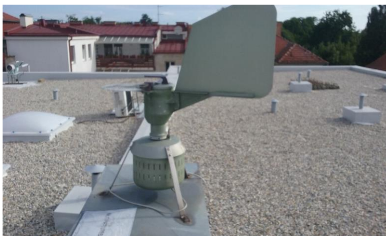
Slika 7: Burkardov volumetrijski aparat (Foto: Majetić Dajana).
