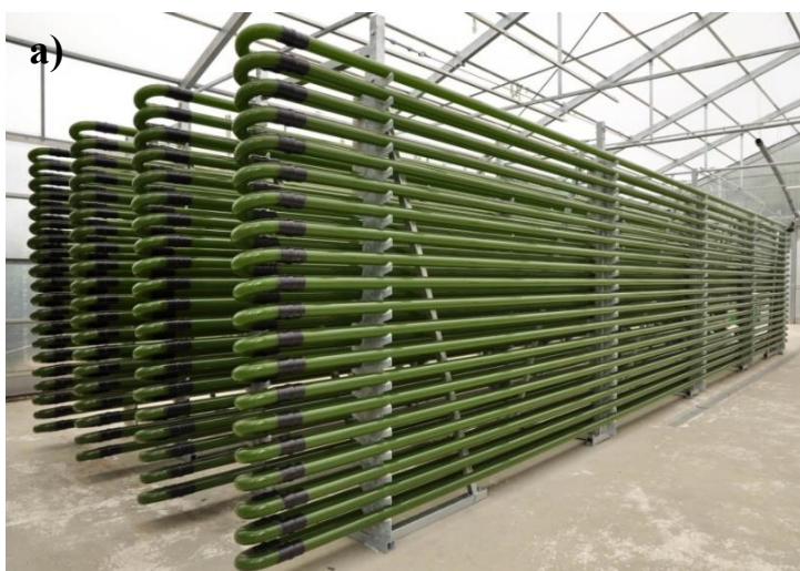
Slika 3. Različiti tipovi zatvorenog fotobioreaktora: a) cijevni bioreaktor (Web 23; b) bioreaktor s imobiliziranim stanicama alga (Web 4)
