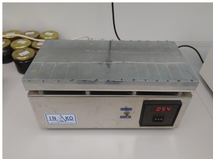
Slika 12. Sušenje preparata na grijaćoj ploči
