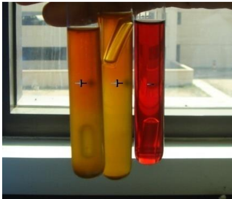
Slika 9. Prikaz pozitivnih i negativnih reakcija u epruvecama prilikom detekcije i brojanja koliformnih bakterija MPN metodom (Web 5)
